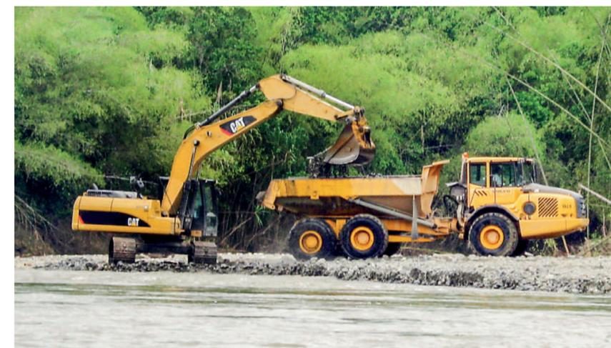
*Extracción de material de arrastre con maquinaria pesada a orillas del río Barragán, cuenca del río La Vieja.*
