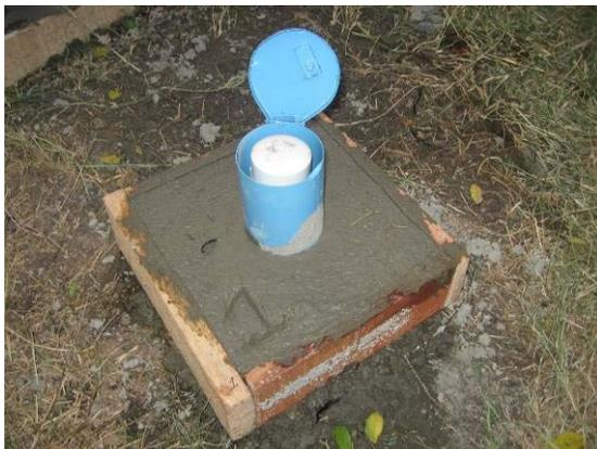
**Fotografía 6. Sellado en concreto y tapa de protección**
