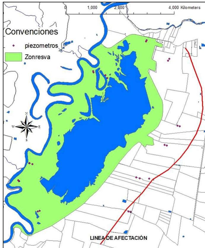
**Figura No. 30.** Línea de afectación por una oscilación de 50 cm del nivel freático en los niveles de la Laguna de Sonso
