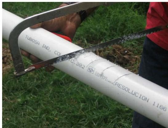
Fotografía 3. Corte de ranuras para la elaboración de filtros.
