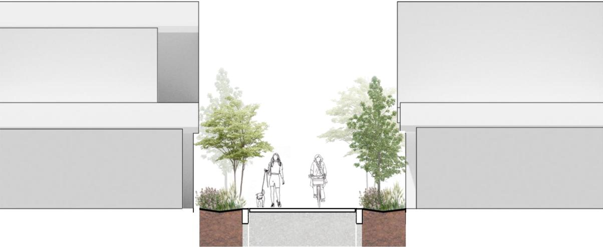
*Figura 44. Calle Local Tipo 1 - Axonometría y Sección de Propuesta*
