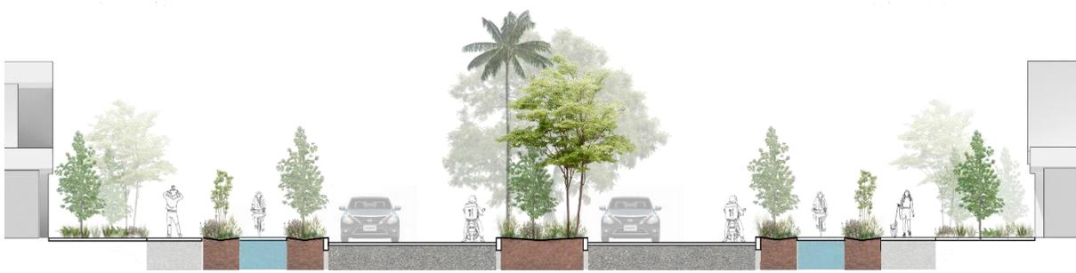
Figura 59. Vía Colectora Tipo 2 - Axonometría y Sección de Propuesta
