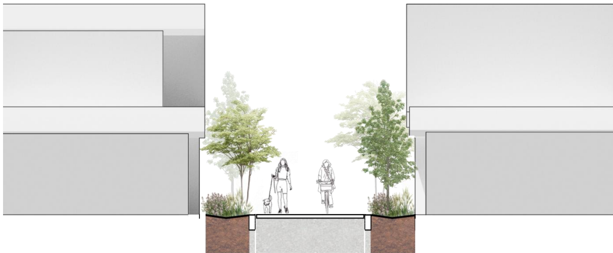
Figura 40. Calle Local Tipo 1 - Axonometría y Sección de Propuesta
