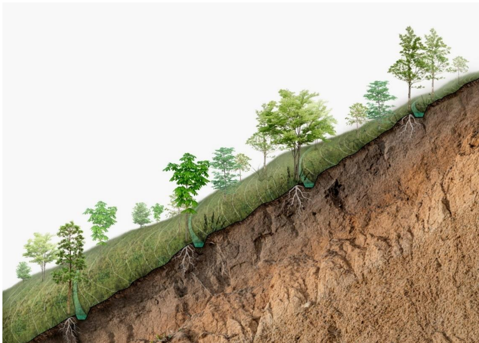
Figura 38. Plantación de Árboles en Zanjas De Infiltración
