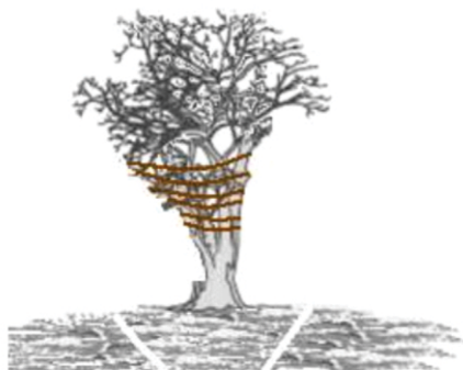
EXCAVACIÓN DEL CEPELLÓN
