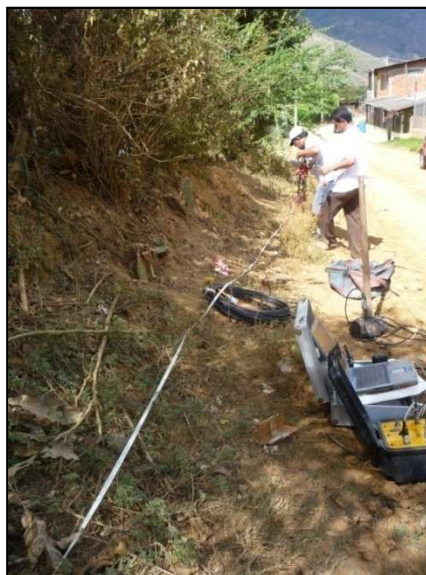
Foto 6.8 Localización Línea de Refracción Sísmica L-4, en el área de expansión oriental de la cabecera municipal.
