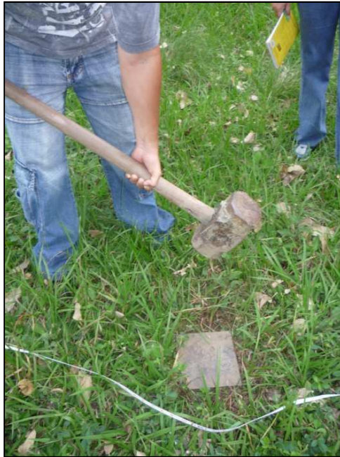
Foto 6.4 Platina y mazo utilizado como fuente de energía.
