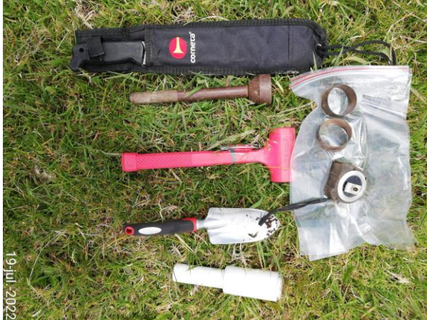
Fotografía 3. Implementos para la toma de muestras de suelo.
