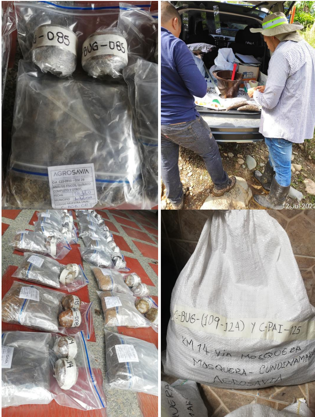
Fotografía 5. Embalaje y rotulado de muestras para envío a laboratorio. Fuente: Elaboración propia.
