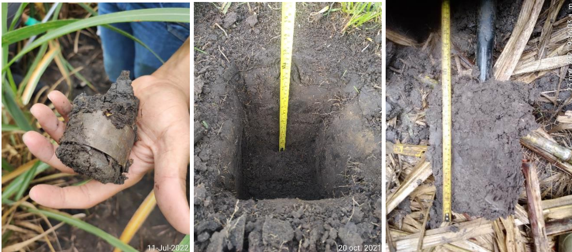
Fotografía 4. Proceso de toma de muestra de cilindro, cajuela para evaluación de perfil del suelo y extracción de tajada para análisis de muestra disturbada.
