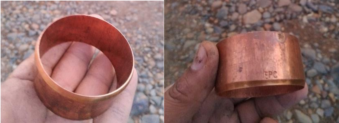
Fotografía 1. Diseño cilindro de muestreo. Fuente: Elaboración propia.
