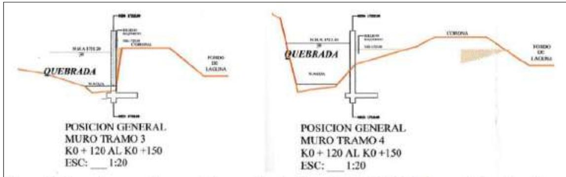
**Figura 9.7.** Diseño del muro de contención en voladizo
