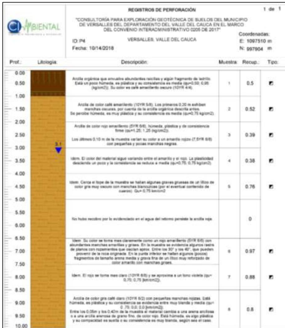
**Figura 7.7.** Perfil estratigráfico establecido P-4. Obsérvense los valores estimados de RQD.
