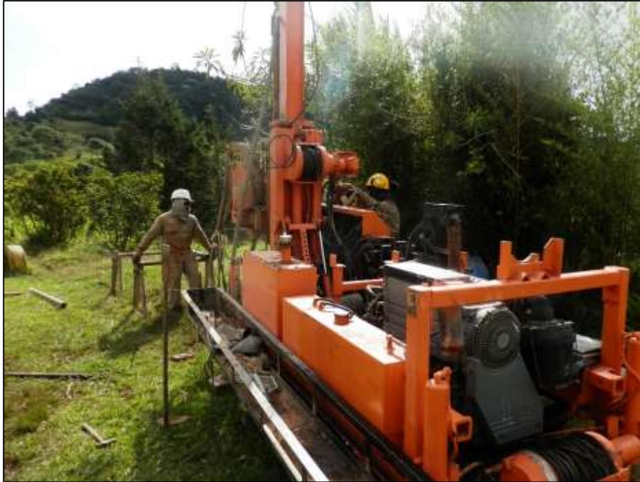
**Figura 7.3.** Máquina (ACKER) usada para las perforaciones
