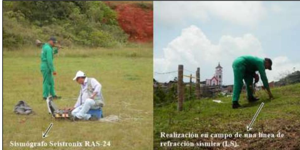
**Figura 7.9.** Realización en campo de una línea sísmica en el municipio de Versalles
