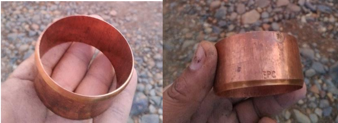
Figura 8. Diseño cilindro de muestreo.
