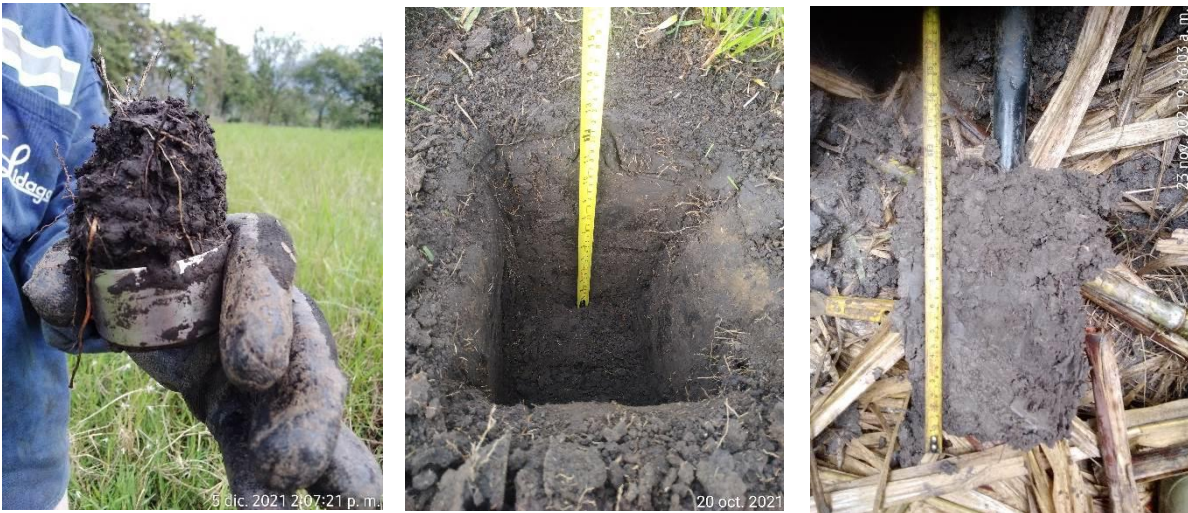
Figura 13. Proceso de toma de muestra de cilindro, cajuela para evaluación de perfil del suelo y extracción de tajada para análisis de muestra disturbada.
