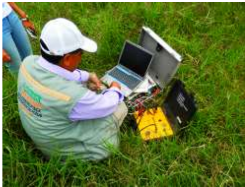
Figura 7.8. Sismógrafo Seistronix RAS-24.
