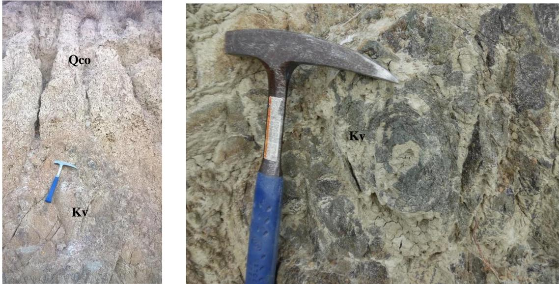
**Figura 7. a.** Afloramiento de basalto suprayacido por depósito coluvial tobáceo. **b.** Detalle de meteorización esferoidal en basaltos. Vista Sur-Norte.
