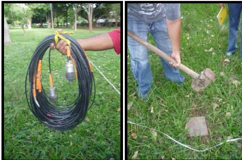
Foto 6.3 y 6.4 Cable de emisión, Platina y Mazo utilizado como fuente de energía.
