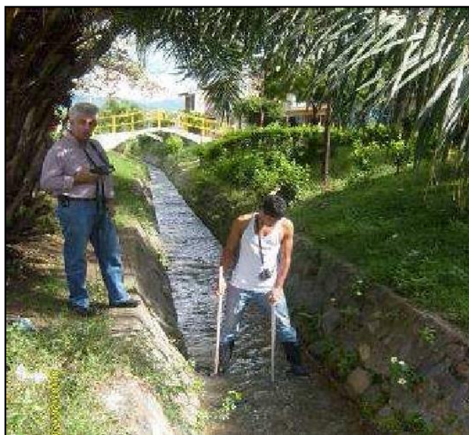
Foto 7.7 Aforo Qda La Pachita 300 m aguas abajo Puente vía alterna entrada a Buga.
