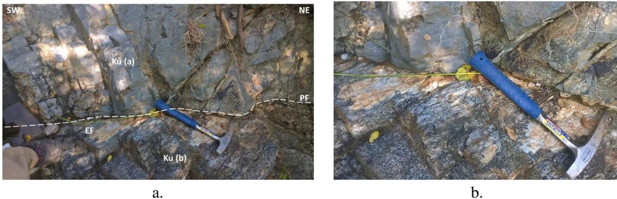
**Figura 15.** Zanjón del Rincón. a. Estación B63, Microgabro (Ku-a) en contacto fallado con gabro hornbléndico (Ku-b). EF (Espejo de Falla), PF (Plano de Falla). b. Detalle del plano de falla.
