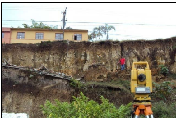
Fotos 3.9 y 3.10 Materialización de puntos con estación total.
