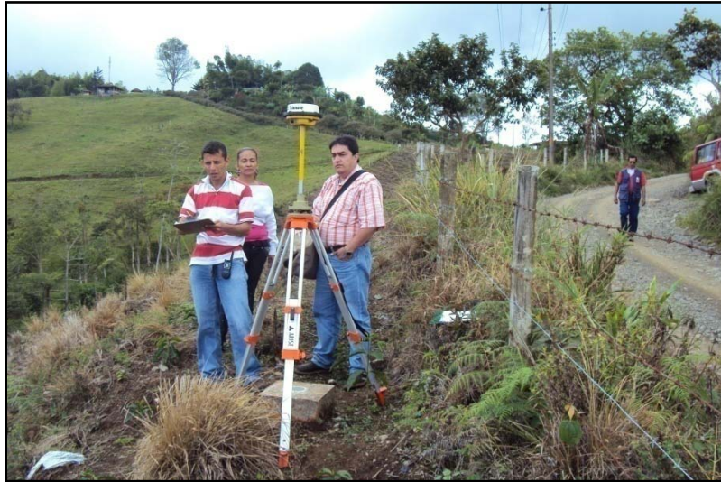
Foto 3.7 Levantamiento y control con GPS del punto IGAC.
