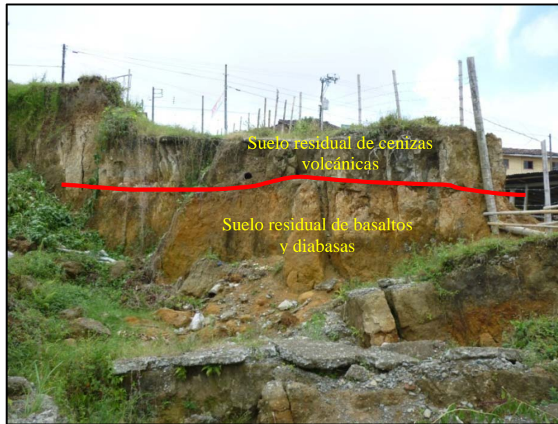
Foto 5.2 Suelos limo arcillosos de color pardo originados a partir de cenizas volcánicas cubriendo la capa de suelos residuales rojizos de la formación Amaime.
