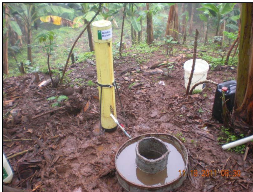
Foto 6.1 Anillos infiltrómetros y la botella de Mariotte
