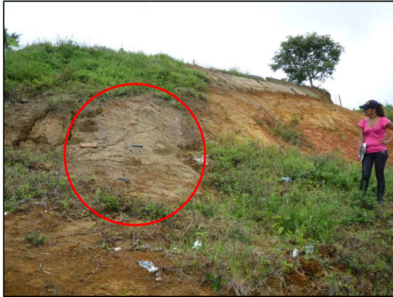
Foto 5.4 Basaltos meteorizados de la Formación Amaine y suelos residuales de color naranja rojizo en el cuerpo del deslizamiento del barrio Monserrate
