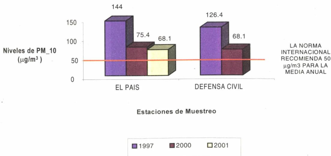
**Figura 24.** Niveles de Material Particulado (PM-10) en el sector industrial de ACOPI –1997, 2000, 2001
