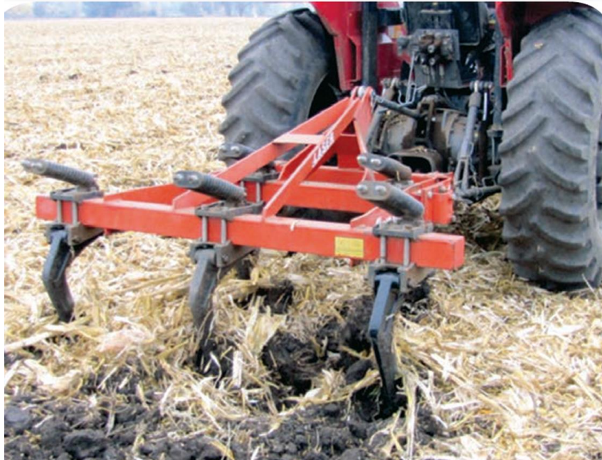
Figura 28. Tractor con subsolador en cultivo de maíz en la cuenca RUT (La Unión).
