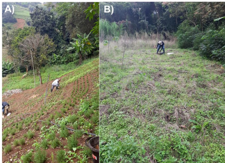
Figura 24. Muestreo de suelos: A) muestreo de suelo disturbado; B) muestreo de suelo sin disturbar.
