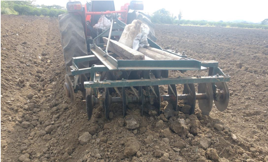
Figura 29. Tractor con rastras de disco realizando labranza para construcción de camas en la cuenca RUT (La Unión).
